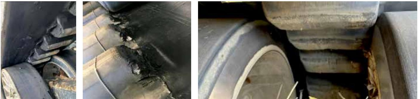
Prüfen Sie zudem regelmäßig die **korrekte Spureinstellung**, um den vorzeitigen Verschleiß der Antriebs- und Führungsstollen sowie die Beschädigung der Lauf- und Umlenkrollen zu verhindern. Durch eine falsch eingestellte Spur kann nicht nur Gummi aus den Raupenkett gerissen werden, sondern die erhöhte Reibung kann auch zu Hitzeschäden an den Fahrwerksteilen, zu Verformungen und Materialermüdung führen. Unsicheres Fahrverhalten und erhöhter Kraftstoffverbrauch sind weitere Folgeerscheinungen.
